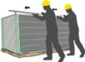
Cuando queden una o dos cintas verticales, empuje lentamente los módulos hacia el soporte estable.
