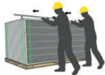
Lorsqu'il reste un ou deux rubans verticales, poussez lentement les modules vers le support stable.
