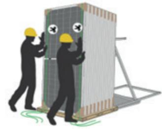
Lorsqu'il reste un ou deux rubans verticales, poussez lentement les modules vers le support stable.
