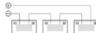
Figura A: conexión en serie
